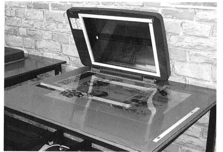
「OMATA スキャナー」。段差によってフィルムにキズや折れがつかないようにデスクに嵌め込まれている
